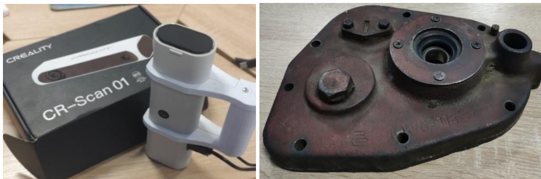
Рисунок 1 – Оптичний сканер CREALITY CR-Scan 01 та об'єкт сканування
