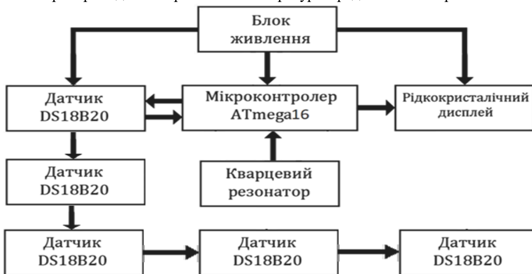
Рис. 1 - структурна схема системи вимірювання температури з датчиками DS18B20
