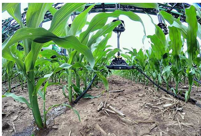
Рис.1 Внесення рідкого добрива у рядок обладнанням Y-DROP
