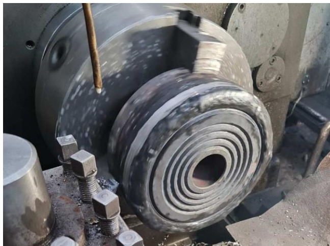
Рис. 3 – Механічна обробка пресової шайби на токарному верстаті
