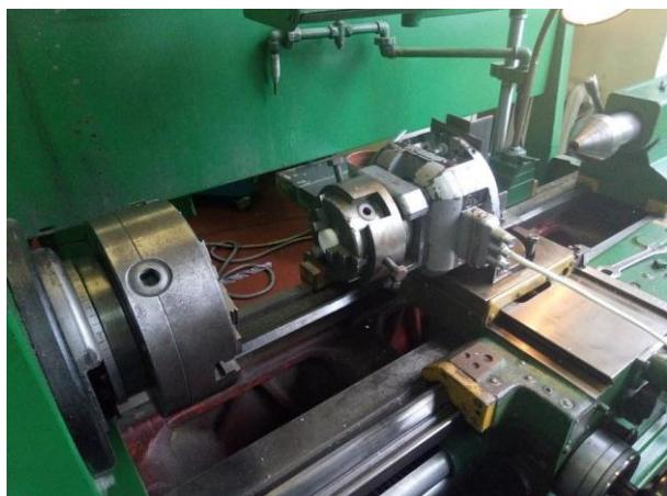
Рис. 1. Свердління отвору в заготовці зі склопластику СТЕФ-У
