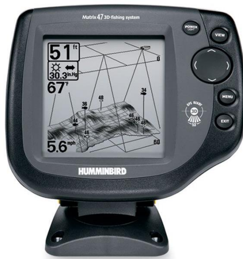
Рис. 3.17 Представлення результатів знімання на дисплеї ехолота
