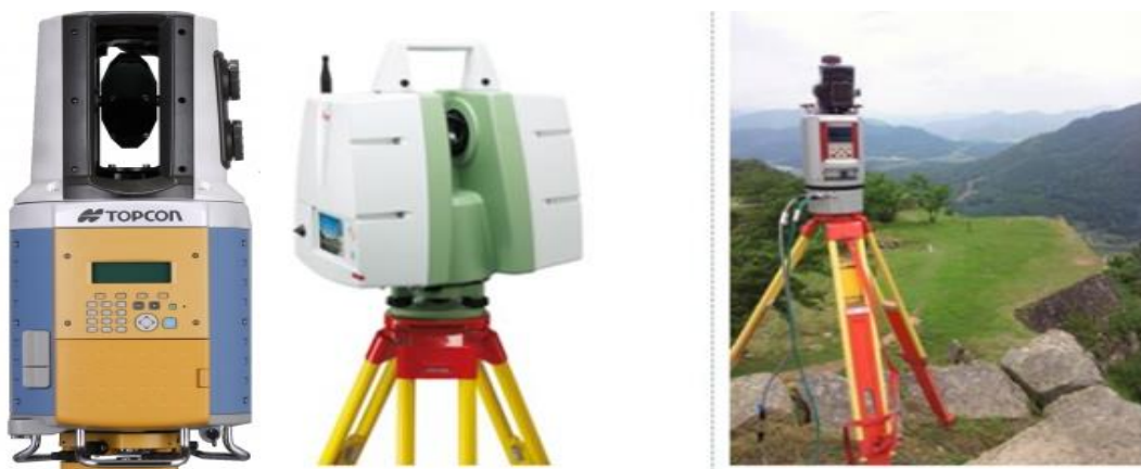
Рис. 3.5. Наземні лазерні сканери з функцією фотознімання: з вбудованою камерою Leica C10; з метричною фотокамерою Riegl VZ-400
