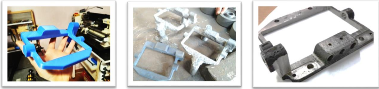
а) б) в) Рис. 1 –Випробування а) майстер-модель б) відливок в) готова деталь
