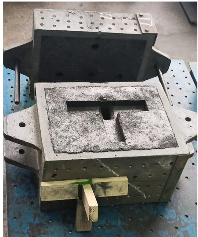
а) б) 1 – напівформа низу, 2 – напівформа верху, 3 – опока, 4 – формувальна суміш, 5 – порожнина ливарної форми
