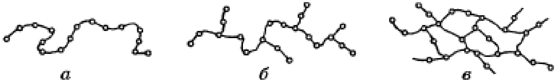
Рисунок 208 – Схеми будови макромолекул полімерів
