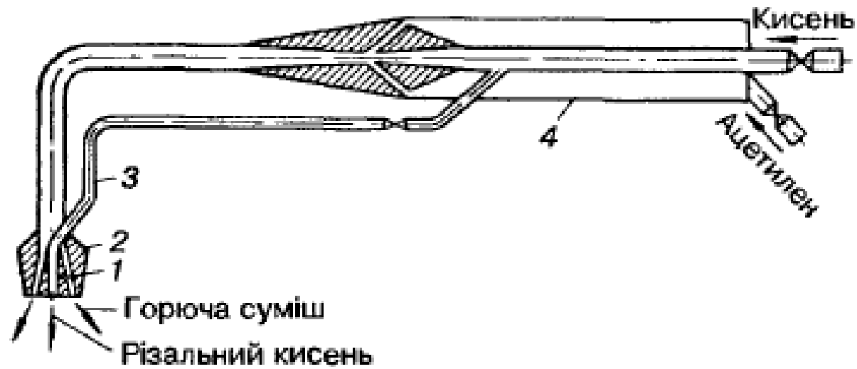
Рисунок 145 – Схема ацетиленокисневого різачка
