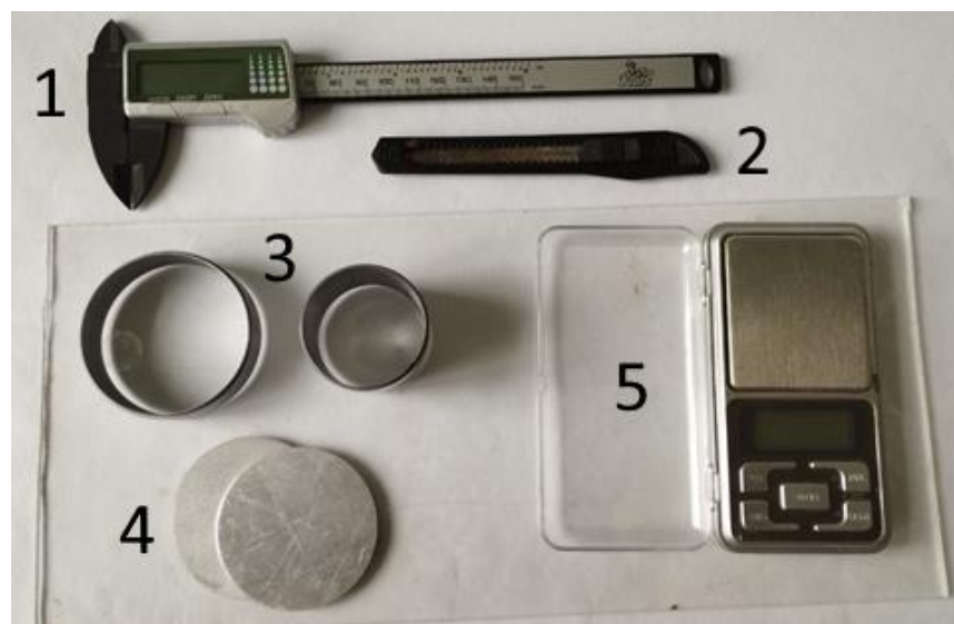
Рисунок 4.2 – Обладнання для визначення щільності ґрунту: 1 – штангенциркуль; 2 – ніж; 3 – ріжучі кільця; 4 – металеві пластинки; 5 – електронні ваги
