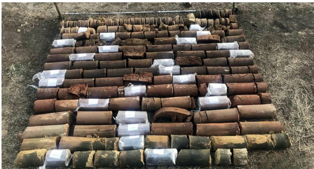
Рисунок 1.16 – Відбір і пакування ґрунту з свердловин [18]
