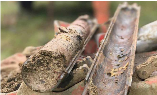
Рисунок 1.12 – Грунтонос: а) схема: 1 – моноліт ґрунту; 2 – корпус; 3 – гільза; 4 – конусна різь; 5 – ніж; б) грунтонос в розібраному стані [11]
