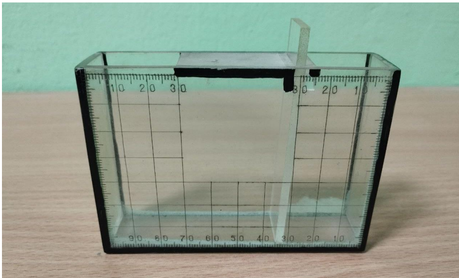
Рисунок 5.6 – Прилад для визначення кута природного ухилу піску
