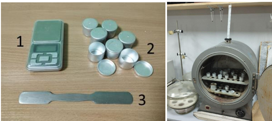
а) Рисунок 6.2 – Обладнання для визначення природної вологості ґрунту: а) 1 – електронні ваги; 2 – бюкси; 3 – шпатель; б) ексікатор та муфельна піч;
