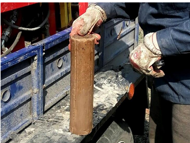
Рисунок 1.13 – Відбір проб ґрунту грунтоносом: а) ґрунт в грунтоносі [12]; б) зразок ґрунту відібраний під час буріння [13]; в) відбір зразків під час буріння [14]
