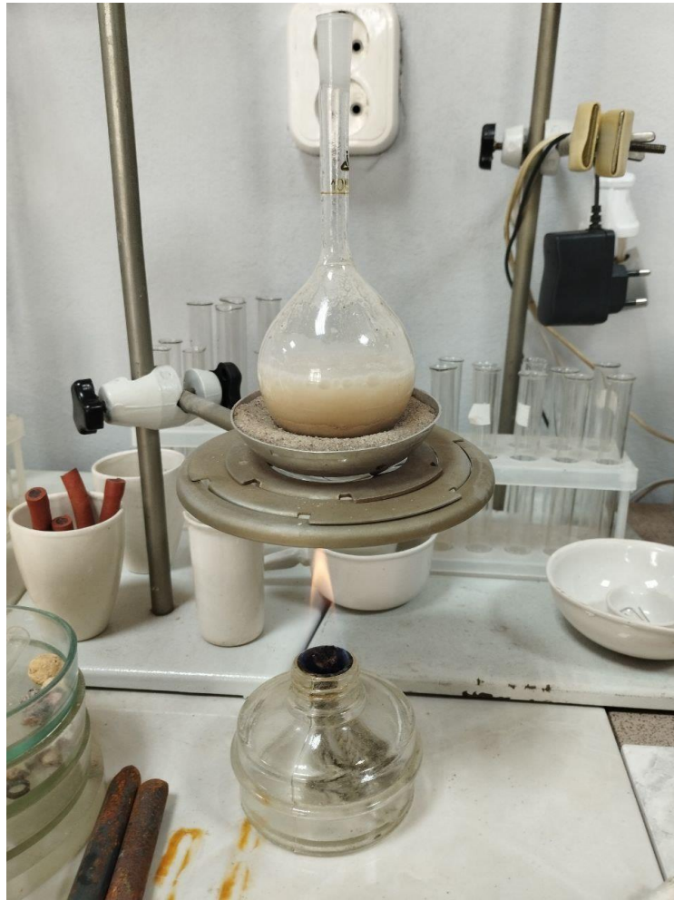
Рисунок 5.3 – Кип'ятіння ґрунту на піщаній бані
