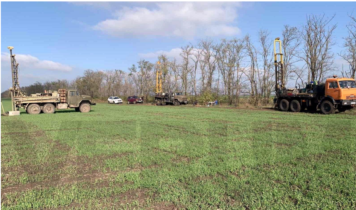
Рисунок 1.9 – Буріння для відбору проб ґрунту: а) початок буріння [7]; б) буріння з промивкою [8]; в) загальний вид бурильних машин [9]
