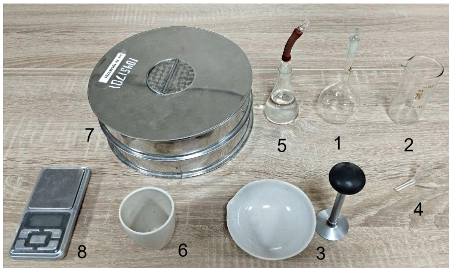
Рисунок. 5.2 – Обладнання для визначення щільності частинок ґрунту: 1 – пікнометр ємністю не менше ніж 100 \text{ см}^3 ; 2 – лабораторна склянка; 3 – фарфорова ступка з гумовим товкачиком; 4 – воронка; 5 – крапельниця; 6 – порцелянова чашка; 7 – сито з отворами 2 мм; 8 – електронні ваги
