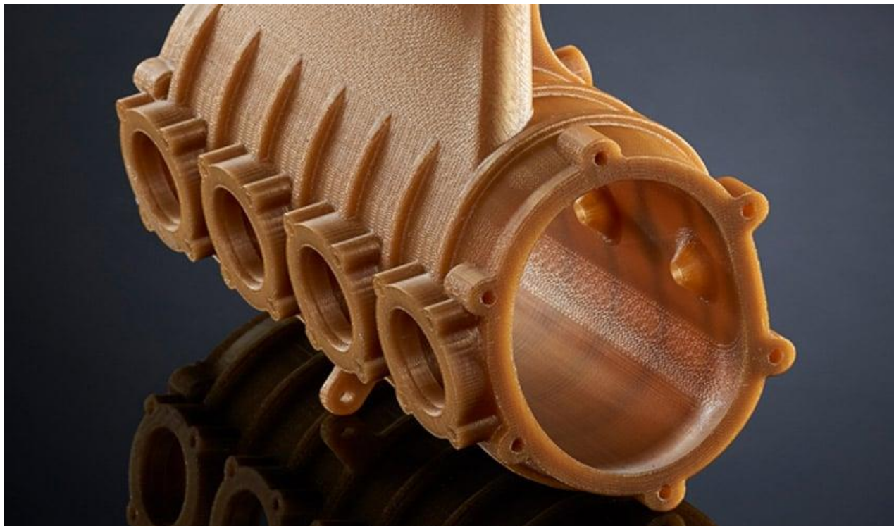
Рисунок 2.6 – Зразок друку поліетерімідом від 3dnatives.com
