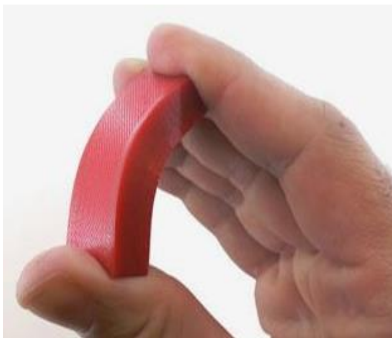
Рисунок 2.5– Ілюстрація гнучкості TPU від tractus3d.com
