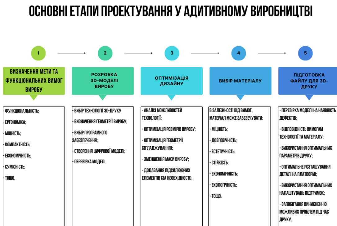
Рисунок 4.5 – Основні етапи проектування у адитивному виробництві.
