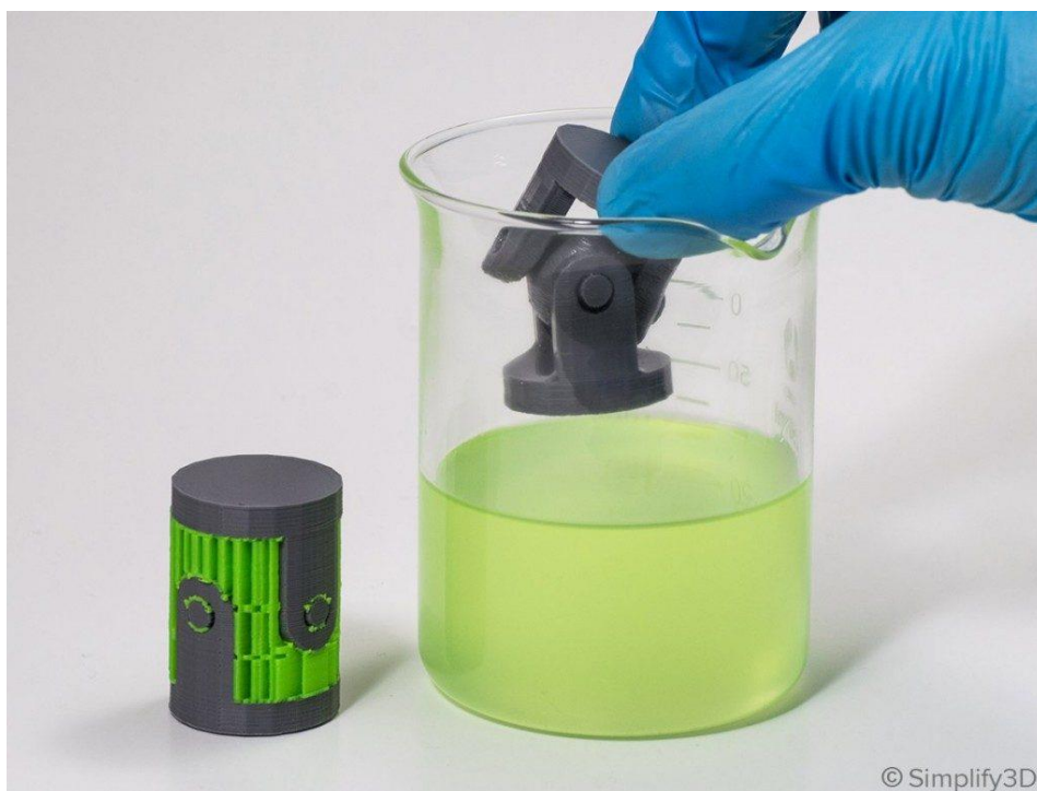
Рисунок 2.3– Розчинення підтримок з HIPS пластика від Simplify3D HIPS став популярним через наступні властивості:
