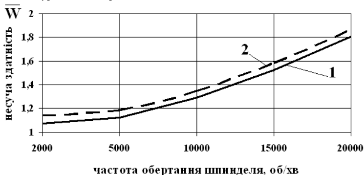
Рис. 3. Несуча здатність ГСО у функції від частоти обертання шпинделя: 1 – схема виконання опори №1; 2 – схема виконання опори №2
