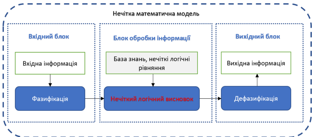
Рис. 3.5. Узагальнена схема процесу обробки інформації в нечіткій математичній моделі
