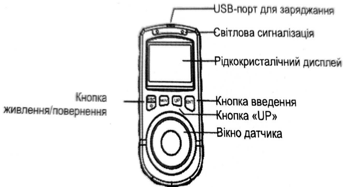
Рисунок 3.2 – Конструктивні особливості газоаналізатора НТ-1805.
