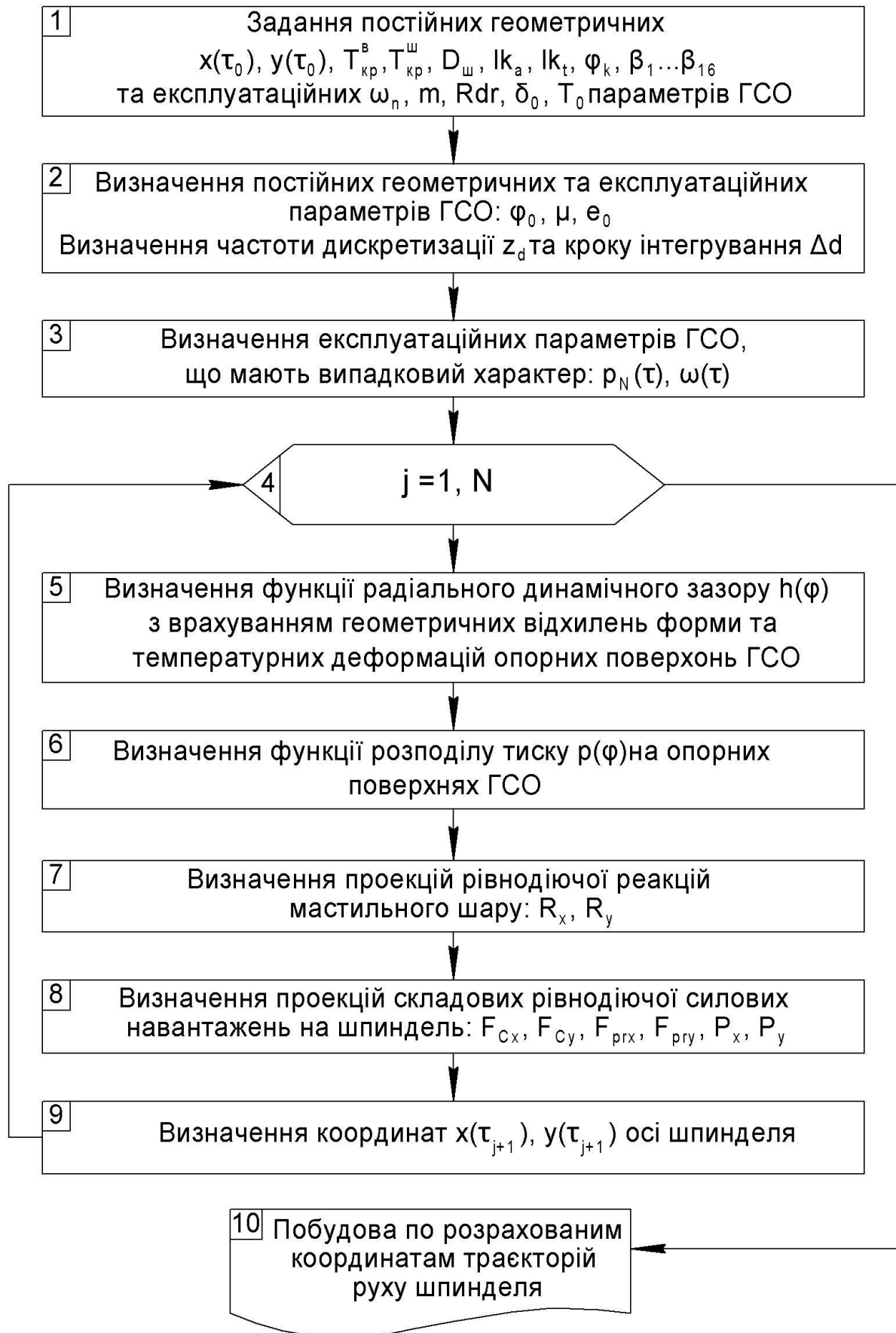
Рисунок 2.11 – Структурна схема алгоритму чисельного моделювання траєкторій руху шпинделя на ГСО
