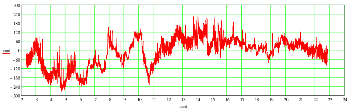
Рисунок И.1 – Відхилення радіальної координати контуру зразка-виробу в кодах АЦП
