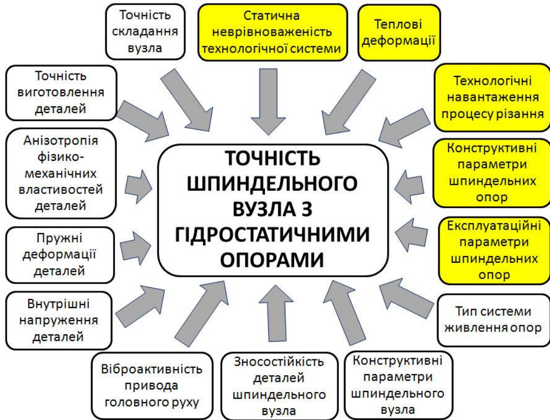
Рисунок 1.4 - Фактори, що впливають на точність шпиндельних вузлів з гідростатичними опорами
