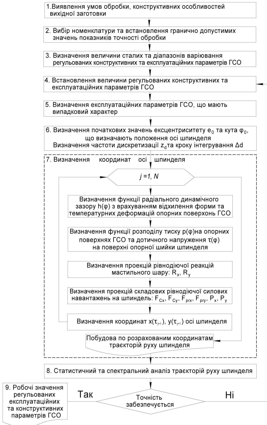
Рисунок 5.1 – Схема алгоритму вибору раціональних експлуатаційних та конструктивних параметрів регульованих ГСО
