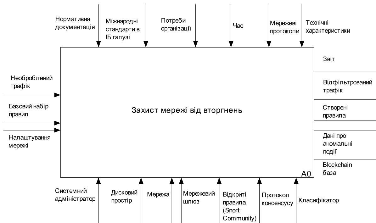
Рисунок 3.1 – Функціональна модель процесу верхнього рівня «Захист мережі від вторгнень»
