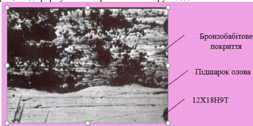
Рис. 1 – Оптична мікрофотографія ( \times 150 ) дослідного біметалевого зразку
