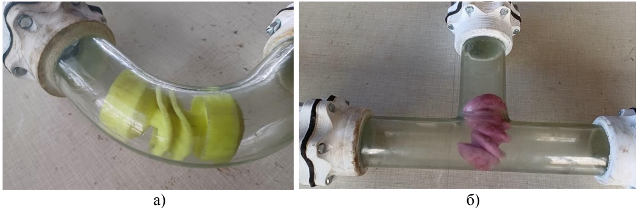
Рис. 2 – Рух циліндрично-дводискового поршня відводом а) та манжетно-чашкового трійником б) трубопроводу
