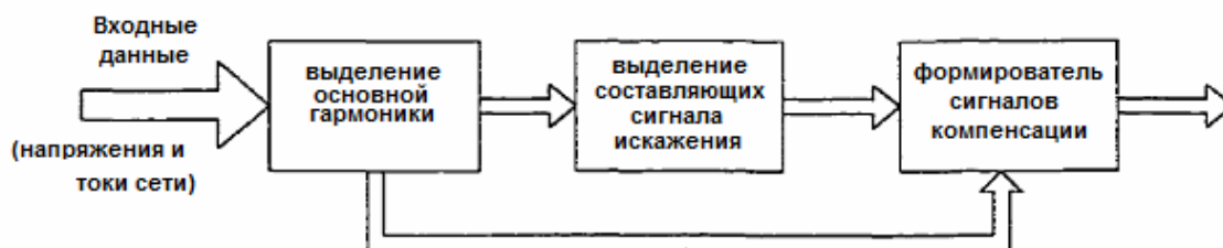
Рис. 3. Структурная схема предлагаемого АФ
