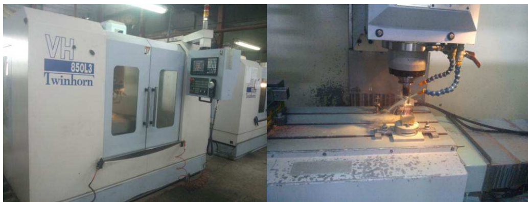
Рис. 9. Зображення верстата і обробки електрода-інструмента
