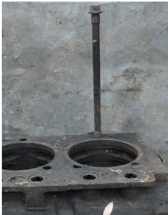
Рис. 4. Місце встановлення болта кріплення в картер двигуна
