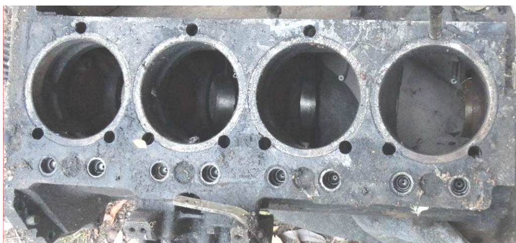
Рис. 3. Схема розташування отворів кріплення картера двигуна
