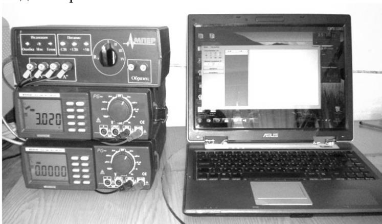
Рис. 2. Внешний вид разработанного измерительного комплекса для проведения исследований вольтамперных характеристик
