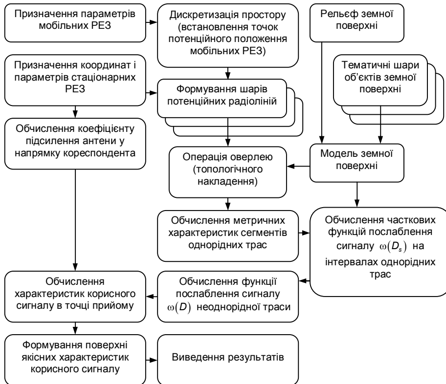
Рис. 3. Блок схема методу кусочно-однорідного представлення радіотрас
