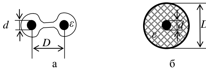
Рисунок 4.1– ВЧ-кабелі: а – стрічковий; б – коаксіальний
