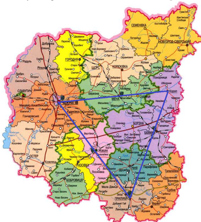
Рис. 6. Схема розташування перманентних GPS-станцій CNIV-Чернігів, PRYL-Прилуки, KОРP-Короп
